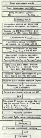
Фиг. 2. Блок-схема решения основной части программной задачи по определению множественной корреляционной зависимости себестоимости изготовления станков от производственно-технологических параметров
