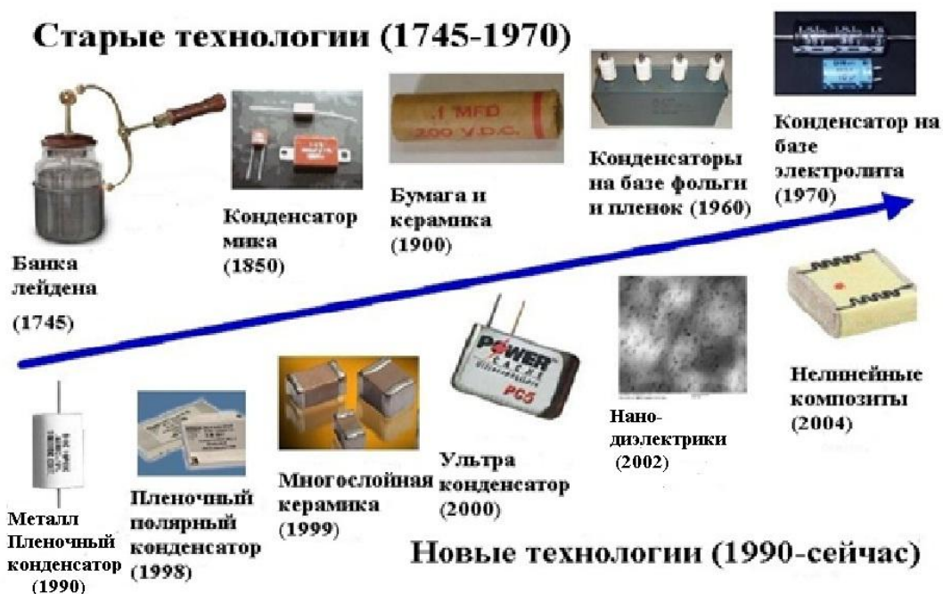
Рис. 6.1. Развитие применения керамики в производстве конденсаторов
