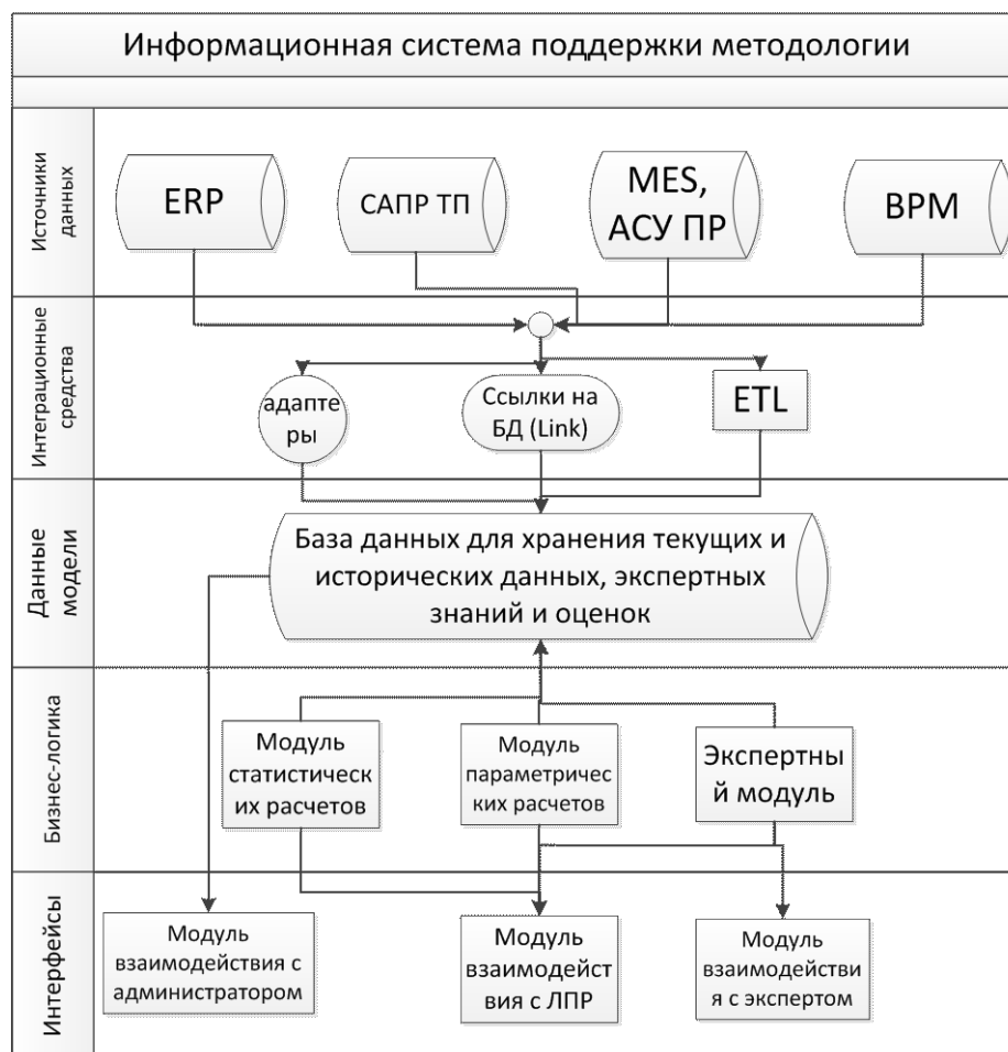
Рисунок 13 — Обобщенная структура информационной системы поддержки методологии
