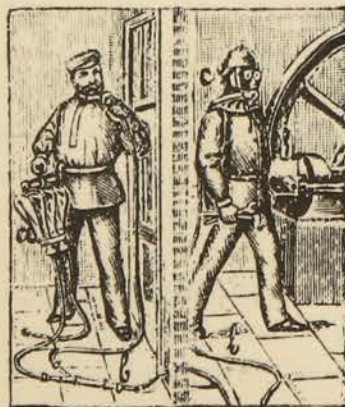
Рис. 54. Костюмъ для входа въ помѣщеніе, съ удушливыми газами или дымомъ. Закрытый шлемъ с, подводная трубка bb и резервуаръ а съ кислородомъ (см. стр. 50).
