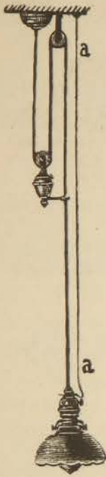
Рис. 202. aa — предохранительный шнуръ у лампы накаиванія.
