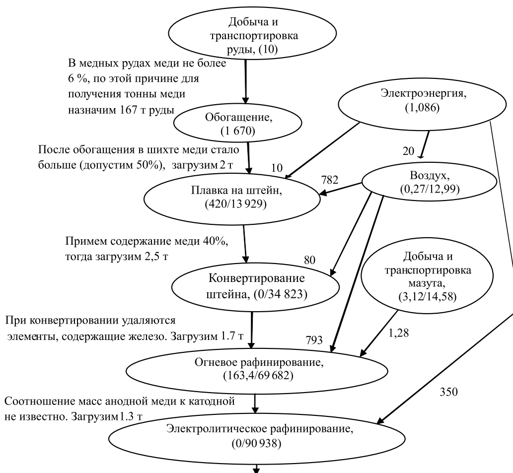
Рис. 2. Граф эмиссий диоксида углерода с использованием автогенного процесса производства медной продукции
