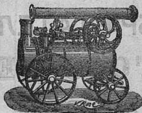
Паровая машина съ горизон- тальнымъ котломъ на коле- сахъ.
