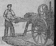
Машина съ вертикаль- нымъ паровымъ котломъ на колѣ- сахъ съ молотилой.
