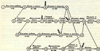
Рис. 5. Комплексный (укрупненный) график возведения объектов одной стройплощадки: события 1—4 — возведение электростанции, события 5—11 — строительство основного корпуса № 1, события 12—15 — котельной, события 16—20 — вспомогательного корпуса № 2
