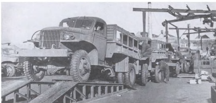
Конвейерная сборка под открытым небом грузовиков «Студебеккеров», полученных по ленд-лизу, на Горьковском автомобильном заводе им. В. М. Молотова, лето 1943 г.
