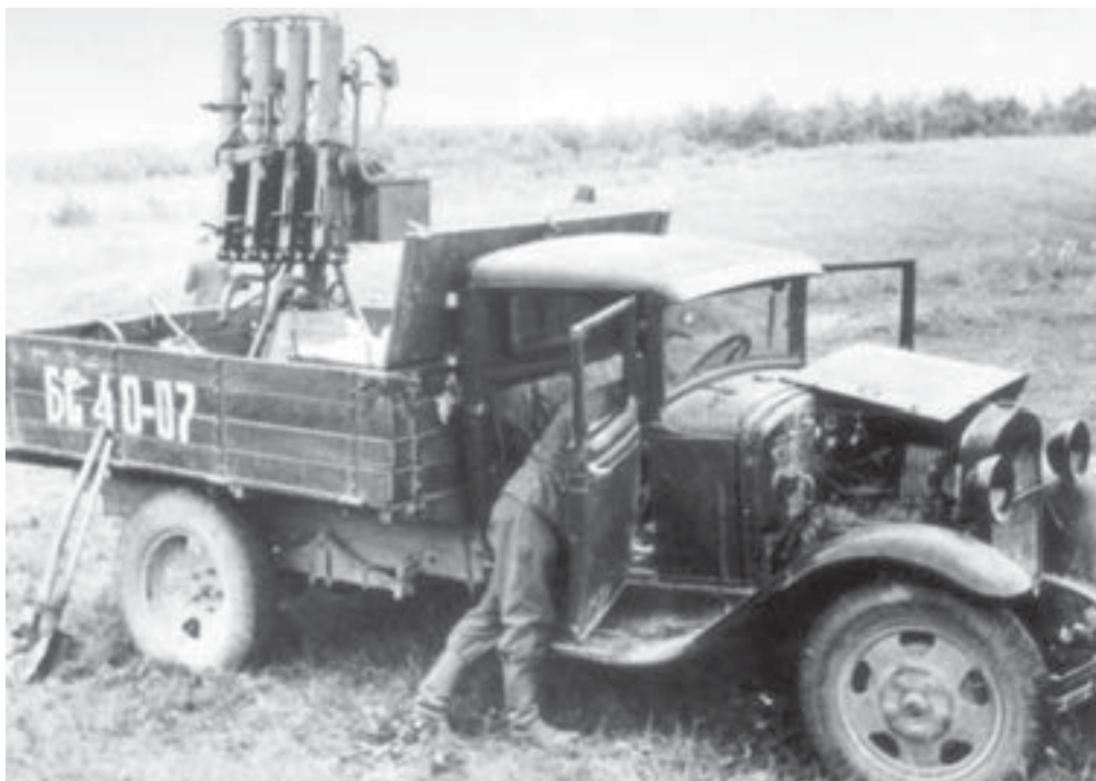
Счетверенная зенитно-пулеметная установка на ГАЗ-АА
