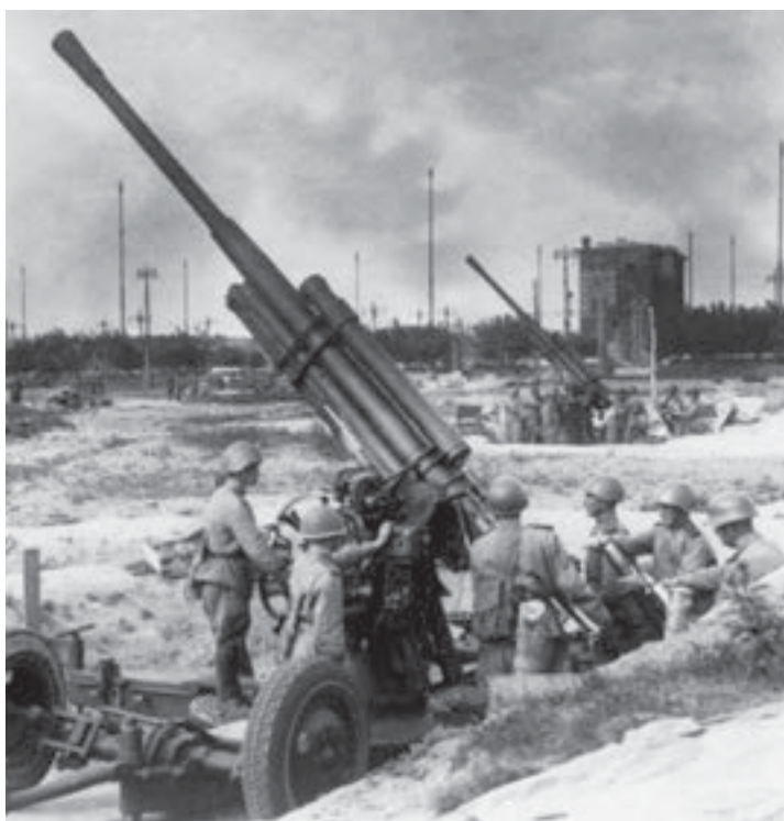
85-мм зенитное орудие 52-К
