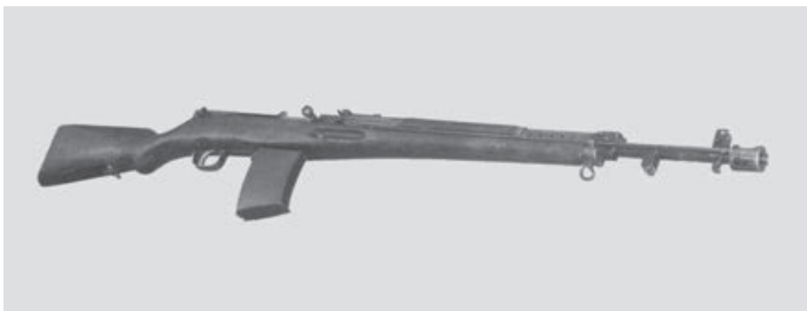
7,62-мм пятнадцатизарядная автоматическая винтовка конструкции С. Г. Симонова (ABC-36)
